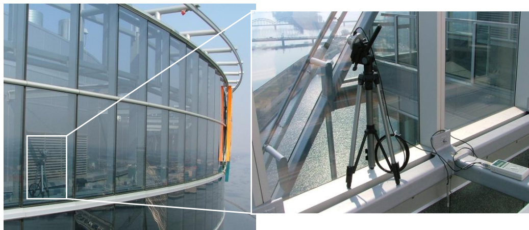
Attēls 2.125. Starojuma intensitātes mērījumi netīrām stikla paketēm uz ēkas jumta.
