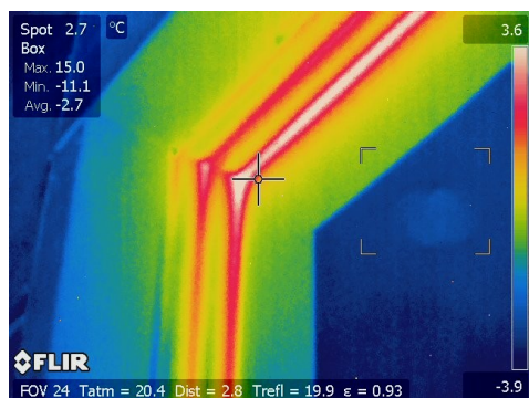
Attēls 5.25. PLY stenda augšējais stūris pie loga un loga augšējais stūris no ārpuses.
