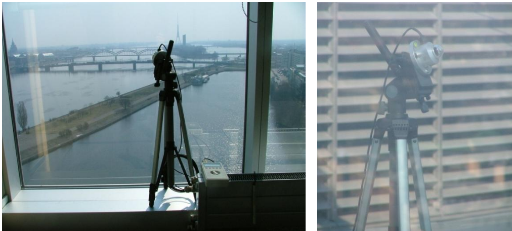
Attēls 2.121. Mērsistēma ar sensoru Hukseflux LP02 un datu uzkrāšanas ierīci Almemo 2290-8 mērījumu laikā.
