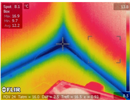
Attēls 5.14. AER stenda apakšējais stūris loga pusē un griestu šuve.
