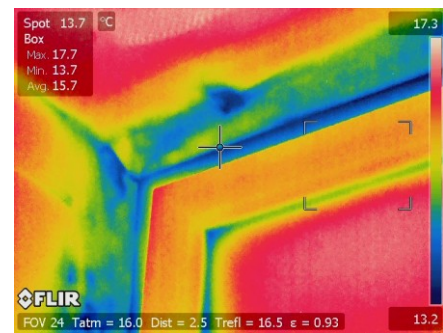
Attēls 5.15. Loga augšējais stūris un durvju apakšējais stūris AER stendā.
