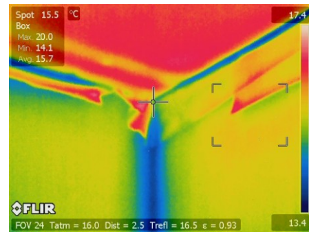
Attēls 5.13. Loga augšējais stūris un CER stenda augšējais stūris durvju pusē.
