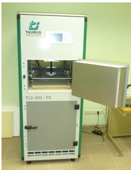
Attēls 2.42. Materiālu siltuma vadītspējas mēriekārta Taurus TCA 500-PX .
