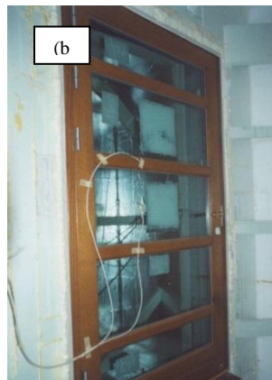
Attēls 2.55. Termokamerā mērījumiem ievietotie objekti – keramiskie bloki (a) un koka durvis (b).
