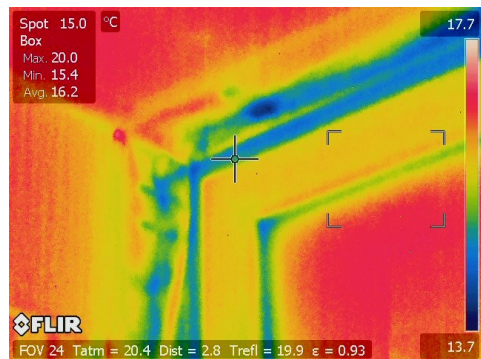
Attēls 5.22. CER stenda augšējais stūris pie durvīm un loga augšējais stūris.
