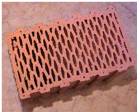
Attēls 2.61. Bloku ar dobumiem raksturošanai lieto efektīvās siltumvadītspējas koeficientu \lambda_{\text{ef}}
