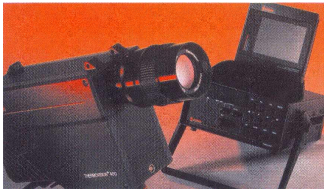
Attēls 2.7. Termogrāfs AGEMA Thermovision 487.
