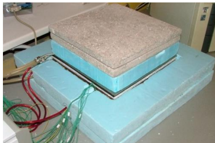
Attēls 2.40. Papildus svars nodrošina nepieciešamo termisko kontaktu starp materiāla slāņiem.
