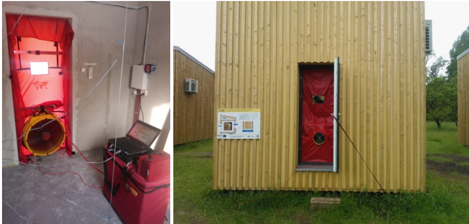
Attēls 5.41. Standartizētas blīvējuma testēšanas norise stendos.
