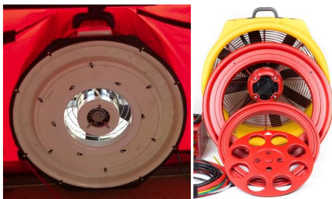
Attēls 2.94. Dažādi ventilatora uzliktņi dažādiem BlowerDoor modeļiem.
