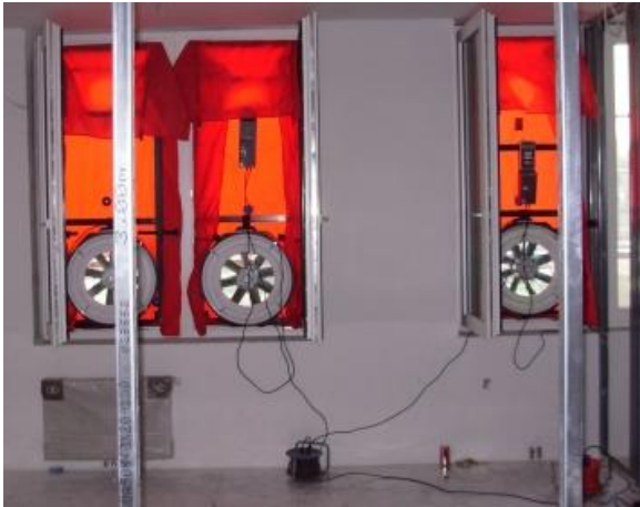
Attēls 2.95. Vairākas BlowerDoor iekārtas dažādās (pa kreisi) vai vienā (pa labi) atverē ēkas čaulā.
