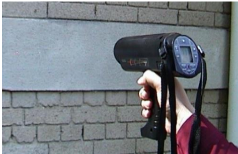
Attēls 2.1. Distances temperatūras noteikšanas ierīce.
