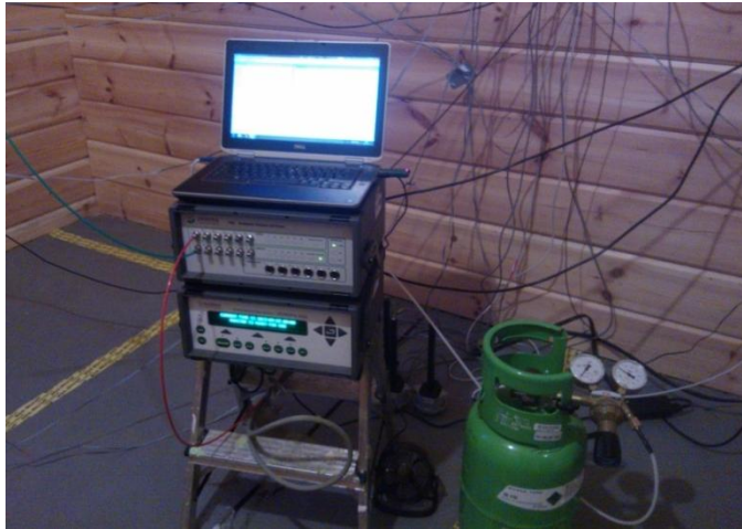
Attēls 2.107. Balons ar iezīmēto gāzi (freons R134a) ir pieslēgts pie dozatora.
