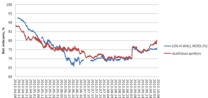
Attēls 6.55. Eksperimentālie rezultāti (zilā līkne) salīdzinājumā ar skaitliskajiem aprēķiniem (sarkanā līnija) laika periodā no 2013. gada aprīļa līdz 2013. gada oktobrim LOG stenda konstrukcijā.
