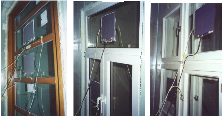
Attēls 2.67. Termiskajā kamerā ievietotas stiklotās durvis (a), logs ar stikla paketi un PVC rāmi (b) un vienkāršs dubultlogs ar koka rāmi (c).
