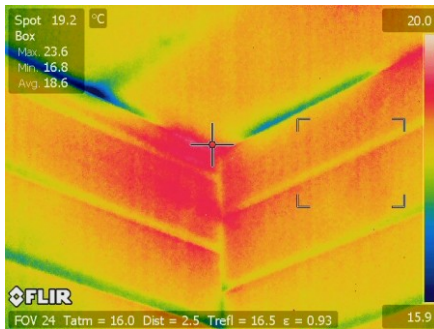
Attēls 5.18. LOG stenda augšējais stūris loga pusē un stenda apakšējais stūris durvju pusē.
