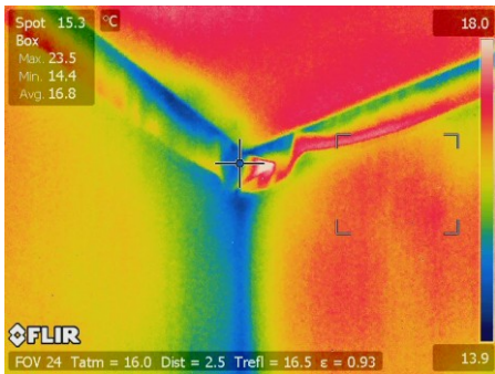
Attēls 5.12. CER stenda augšējais stūris loga pusē un loga apakšējais stūris.
